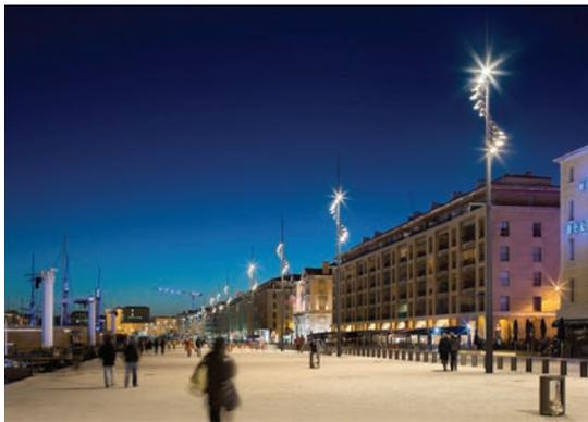
Siebzehn 16,5 Meter und acht 23,5 Meter hohe Olivio-Mastleuchten in Sonderausführung strukturieren den Raum und beleuchten zugleich die immens großen Quai-Flächen bis zur Wasserkante.
