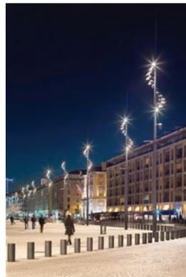
Die Leuchten sind mit 90 W oder 140 W Cosmopolis Lampen bestückt und in unterschiedlich großen Gruppen spiralförmig um den Mast angeordnet.
