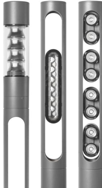
01 – 04 Lif folgt konsequent einem modularen Konzept: Masten in variablen Höhen tragen die mit einer ovalen Aussparung versehenen Aufnahmeelemente. Diese können vollständig oder auch nur teilweise bestückt werden und lassen sich frei zwischen 0° und 360° drehen. Neben den zahlreichen Komponenten für die Beleuchtung stellt Selux jetzt eine ganze Reihe neuer Funktionsmodule vor.
